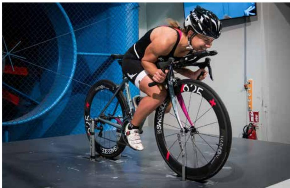
Pédaler (E) entraîne une perte de 5 watts par rapport à la référence A. Pire encore, placer le pied côté vent en bas (B) signifie 26 watts de perdus.
