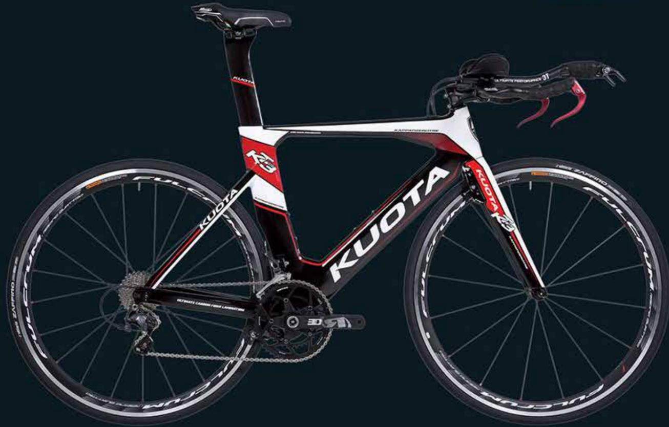
Le Kuota KT03 débarque sur la planète Triathlon ! Nouveau cadre profilé avec étriers de freins aéro derrière la fourche et sous la boîte de pédalier, et tige de selle aéro réversible... Un vélo polyvalent et confortable pour les passionnés de Tri !
