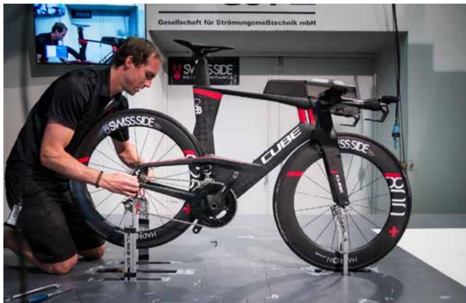
Le temps a manqué pour monter une paire de 48mm à titre de comparaison, cependant les ingénieurs de Swiss Side nous confient que le gain aérodynamique est doublé en passant de la 480 au 625. On en conclut qu'une hauteur de jante de 60mm environ fait très bien l'affaire du triathlète polyvalent, particulièrement sur les parcours souvent vallonnés des triathlons français.
