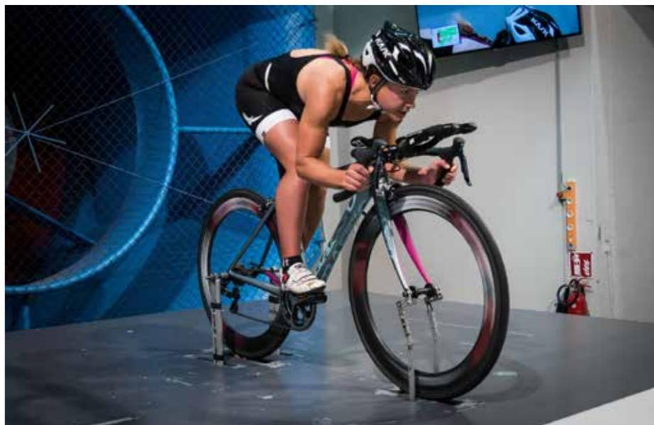
Les tests se terminent par quelques détails finaux pour compléter l'analyse. Ici, simulation de la descente du Ventoux puisqu'un vent latéral arrive de trois-quarts face. Vous avez les mains en bas du guidon et les pieds...
