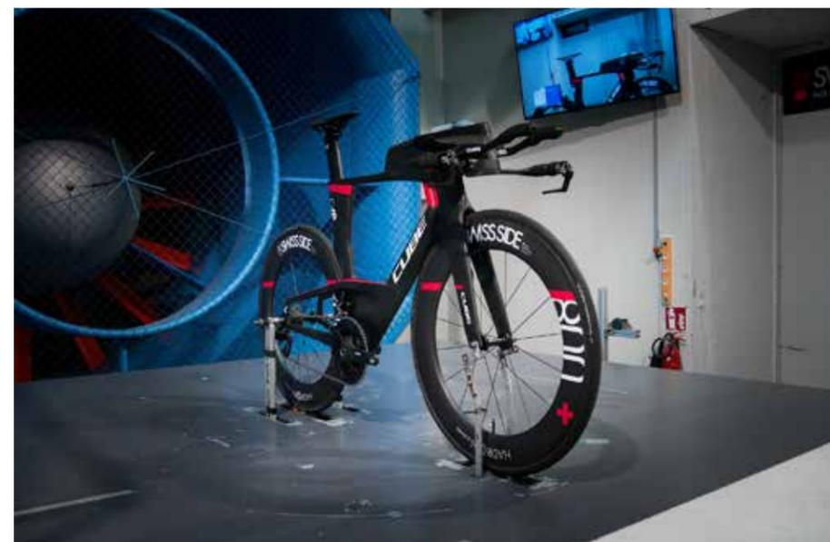
Le côté impressionnant vient de l'immense turbine bleue et rouge à un bout de la plateforme, et le baillant trou noir à l'opposé. En aspirant l'air d'un côté à l'autre, les coefficients de résistance de l'objet au centre peuvent être mesurés et comparés. Les mesures s'effectuent à une vitesse théorique de 45 km/h, et les différences de performance sont retranscrites en watts, histoire que tout le monde s'y retrouve.
